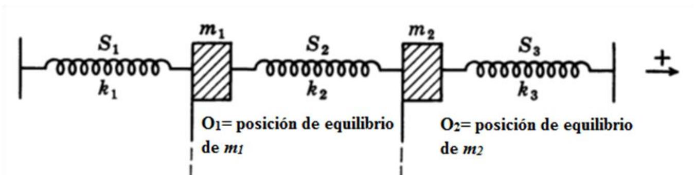
Aquí  $O_1$  es la posición inicial del primer cuerpo y  $O_2$  es la posición inicial del segundo cuerpo. Los cuerpos pueden ser cambiados de su posición de equilibrio mediante mover cualquiera de los cuerpos en cualquier dirección y luego soltarlos. Un ejemplo de esto es,
